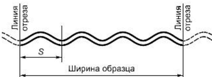
Рисунок 19 - Схема обрезки целых листов перед испытанием
