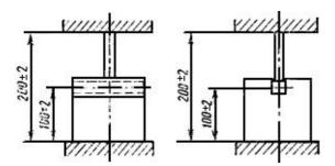
Допускается симметричная обрезка углов образца, закрепляемого в нижнем зажиме разрывной машины, при применении зажима длиной менее 100 мм.
